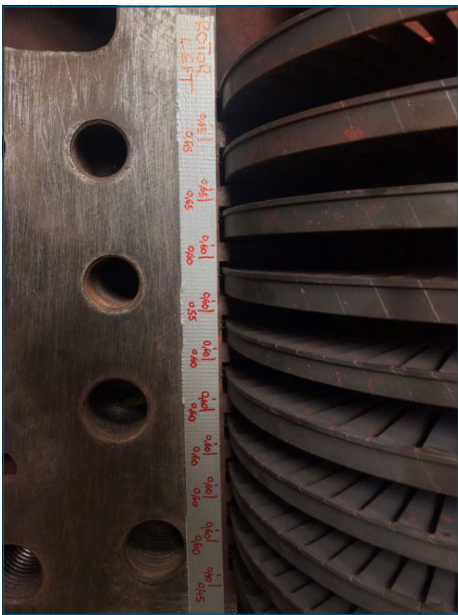
SPIELEMESSUNG DER LABYRINTHE AN DEN SCHAUFELRÄDER
