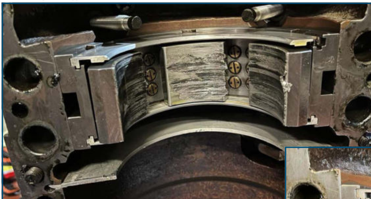
LAGERSCHADEN NACH AUSFALL DER NACHLAUFKÜHLUNG
