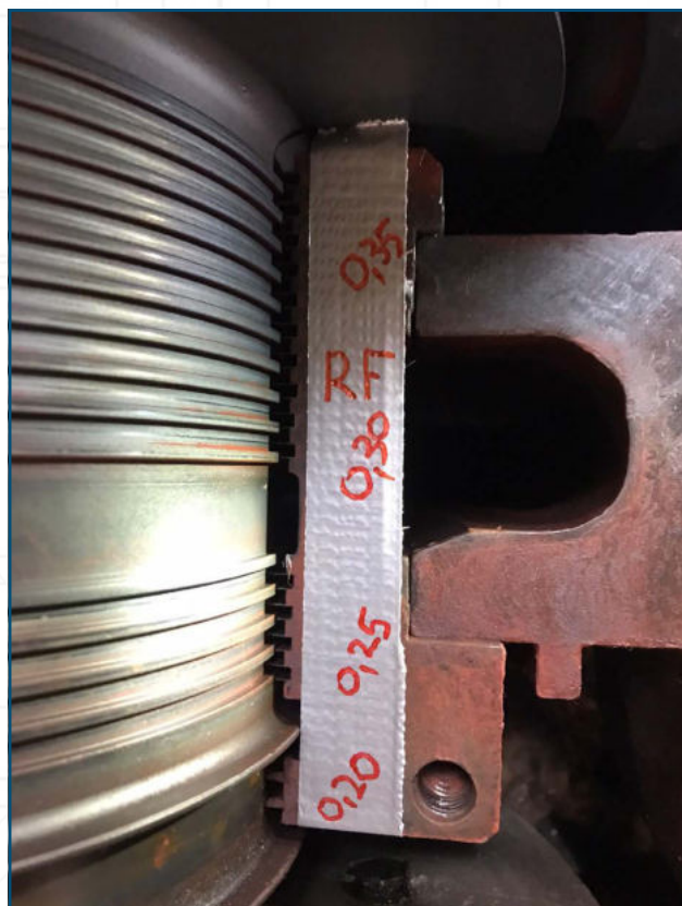
SPIELEMESSUNG DER LABYRINTHE AN DER STOPFBUCHSE
